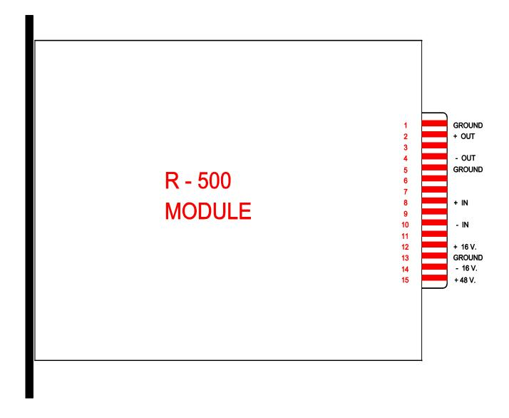
FIG. 3 500 Series module edge connector
